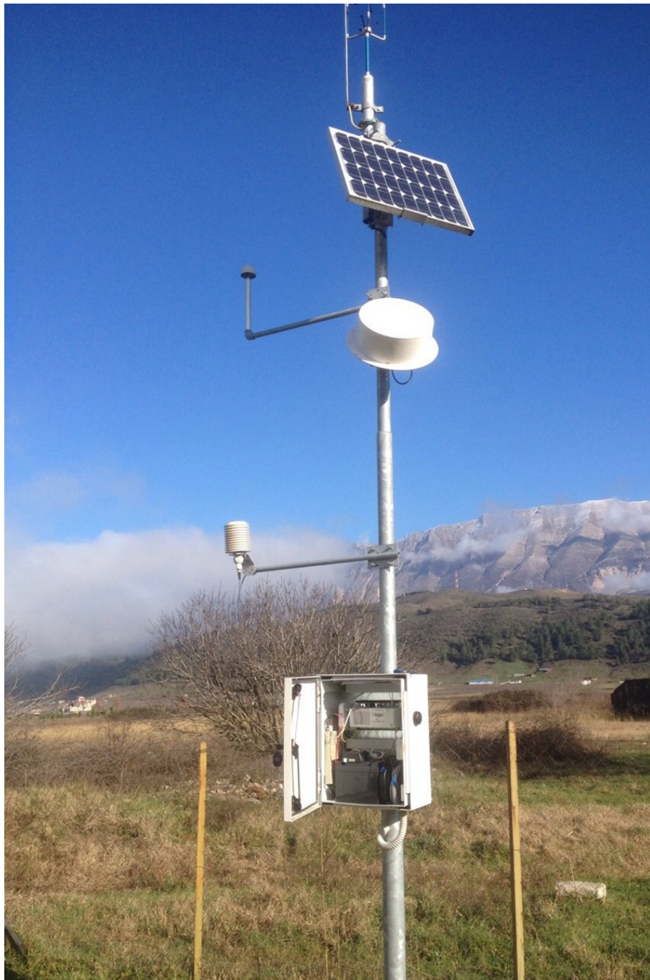
Αυτόματος Μετεωρολογικός Σταθμός του Εθνικού Συστήματος Παρακολούθησης στην Αλβανία
